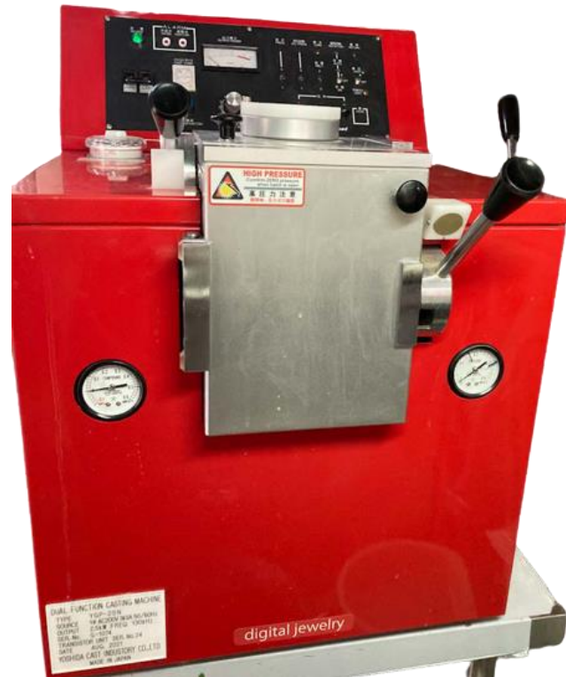
1: デジタルジュエリー(R)ファクトリ仕様鑄造機(YGP-2SN/DJ)
